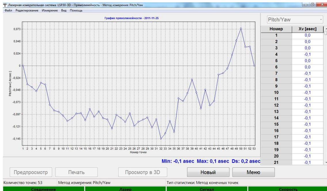
РИС.9.9. ОКНО АНАЛИЗА ДАННЫХ ИЗМЕРЕНИЯ PITCH/YAW
