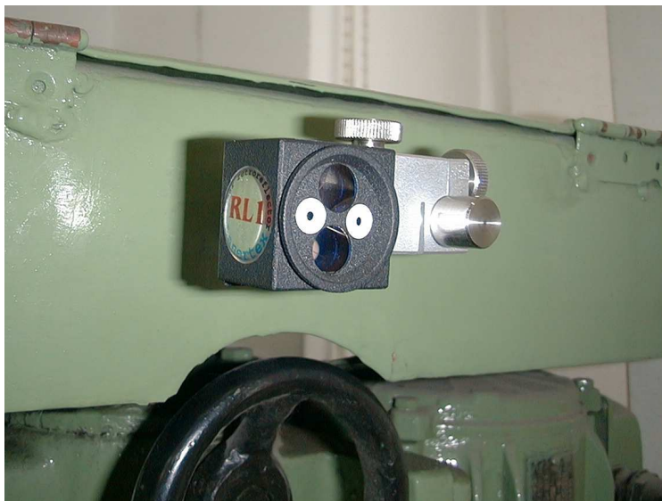
РИС.10.12. ПРИМЕР ПРАВИЛЬНО РАСПОЛОЖЕННОГО РЕТРО- РЕФЛЕКТОРА
