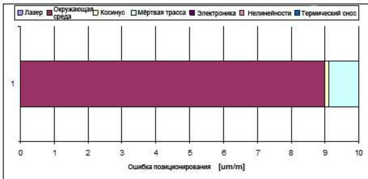
Рис. 2.7. Подсчёт ошибок при наиболее грубой погрешности кондиционирования системы, без компенсации влияния атмосферы.
