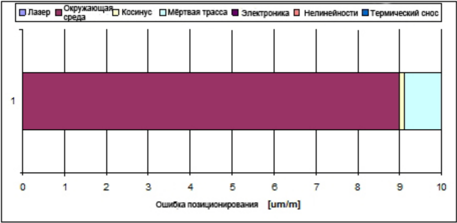
Рис. 11. Подсчёт ошибок при наиболее грубой погрешности кондиционирования системы, без компенсации влияния атмосферы.
